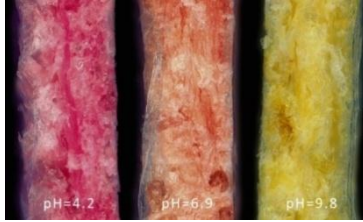
Obr. 11: Homogénny priebeh neutralizácie v pričnom reze vzoriek z kalibračného radu
