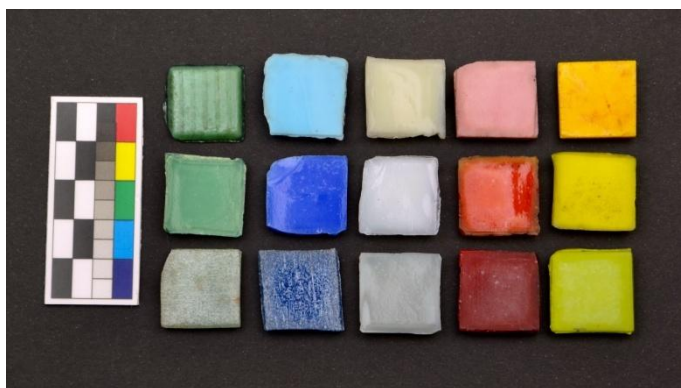
Obr. 1: Sintrovaná mozaika je charakteristická zaoblenými hranami, rozměr kostek je 20 x 20 mm.
