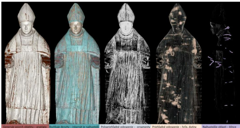
Obr.16a, b, c, d, e: VRT (3D) z CT – Volume Rendering Technique (5 druhov zobrazení): 17a zľava generuje povrch objektu – analógia, b: rozlišuje denzity – inkarnát je najhustejší, c: polopriehľadné zobrazenie – zvýraznil sa ornament, d: priehľadné zobrazenie – hrče, dutiny, spoje, e: najhustejšie klince.
