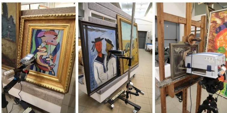
Obr. 3: Užítí mobilních přístrojů při měření: rentgenový fluorescenční analyzátor, Ramanův a infračervený spektrometr s externí reflexí. Fotografie © 2023 Národní galerie v Praze.
