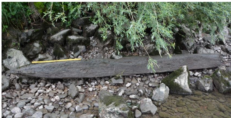
Obr. 1: Hlohovec. Drevený kôl z mostovej konštrukcie so železnou špicou.
