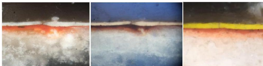
Obr. 9a, b, c: nábrus z estofada na rochete prevedeného bielou farbou, fotografia nábrusu v UV: tak ako pri fotení sochy aj tu sa fólia zobrazuje ako tmavá, dôkaz olovenej beloby v olovej vrstve na rochete.
