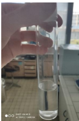
Obr. 22: Vzorový príklad: Pridanie vody k PFH-voda pláva na povrchu; pridanie cca vyše 0,5 ml IPA-disperzia sa zakalí; vyčírenie po pridání dostatočného množstva IPA
