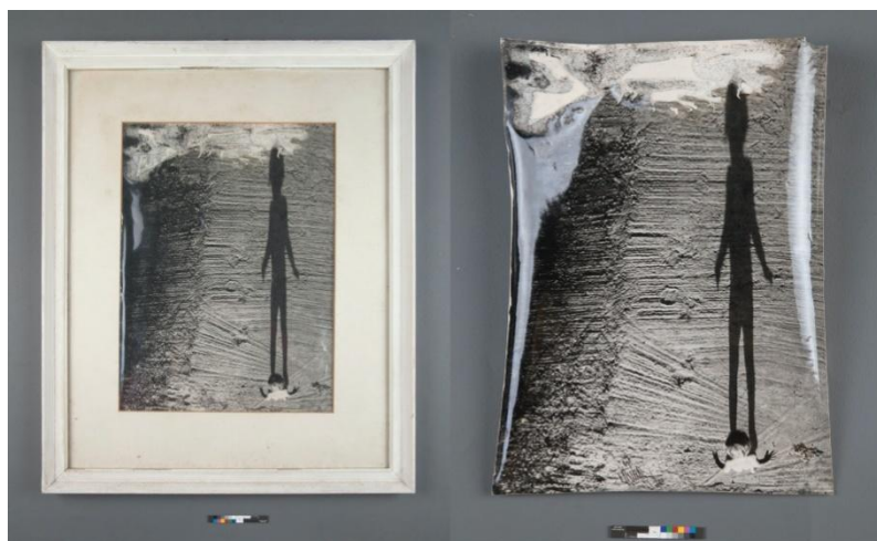
Obr. 1: Príklad solubilizácie emulznej vrstvy a deformácie papierového nosiča na želatínovej fotografii Ecce Homo od Antona Štubňu.
