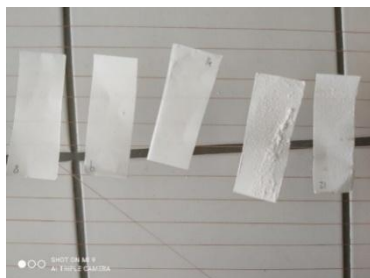
Obr. 24: Testovací papier NOVO bezdrevitý (N-LF) modifikovaný príslušnými modifikačnými sústavami, použitý na meranie povrchového pH. Zľava vz. 8B, 9B, 14B, 15B a 12B.
