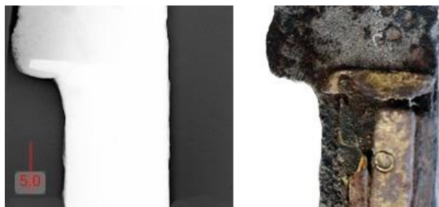
Obr. 5: . RTG snímok odkryl fragment záštity. Vpravo detail originálu.
